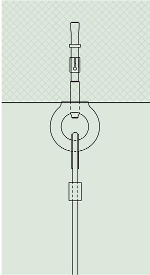
Fixierung durch Bolzenanker und Rundring
